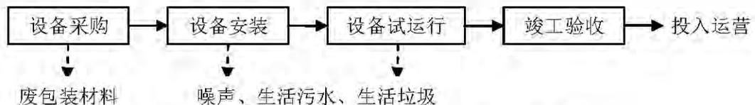
图 4-1 施工期工艺流程及产污位置图
